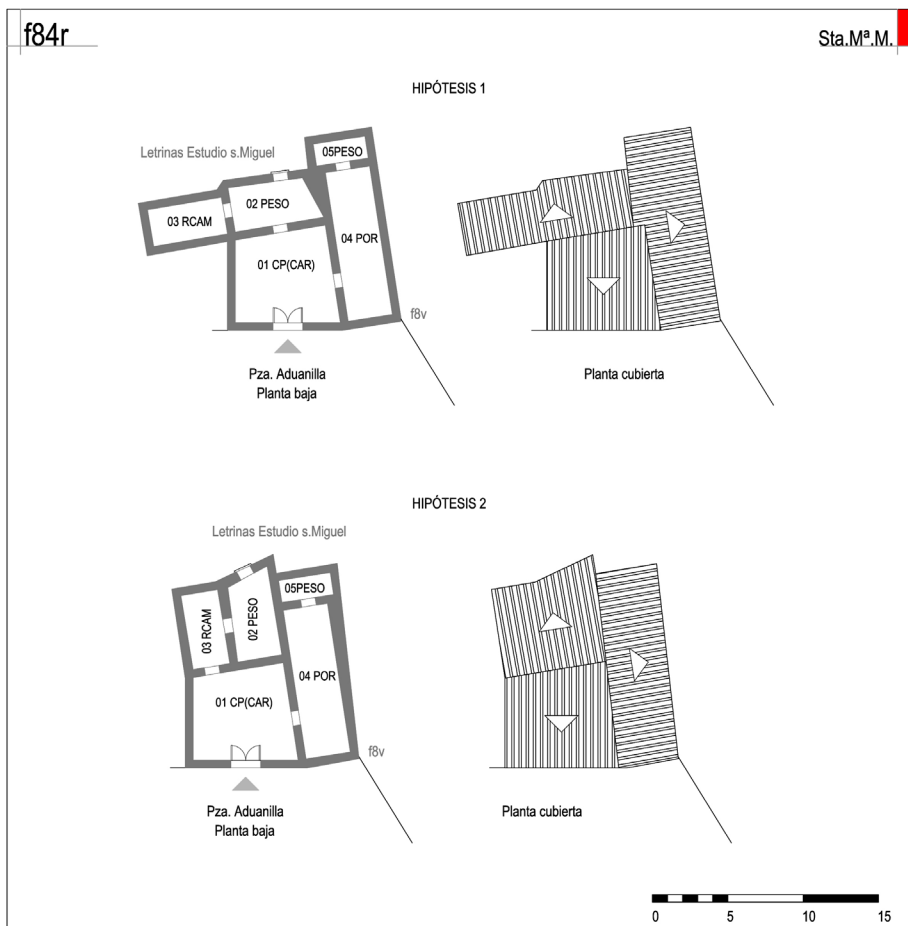
FIG. 10. Dibujo de la casa-carnicería f84r, llamada de los Clérigos, en la plaza de la Aduanilla, en Santa María la Mayor 25 . Elaboración propia. Escala en varas castellanas.
