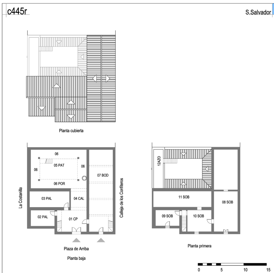
FIG. 6. Dibujo de la casa-bodega c445r en la esquina de La Costanilla y la Plaza de Arriba de San Salvador. Elaboración propia. Escala en varas castellanas.
