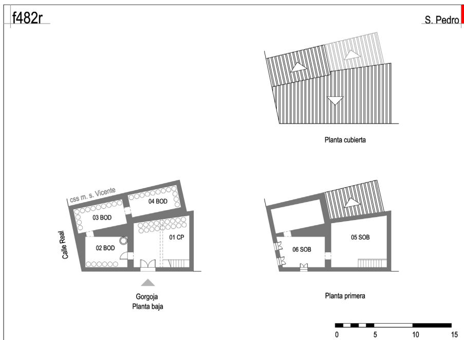
FIG. 5. Dibujo de la bodega f482r esquina entre las calles Gorgoja y Real (al Pozo de la Leona, calle Vinatería) en San Pedro. Elaboración propia. Escala en varas castellanas.
