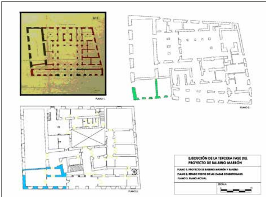
FIG. 8. Ejecución de la tercera fase del Proyecto de Balbino Marrón. 1869. Plano: Manuel Buzón Alarcón.
