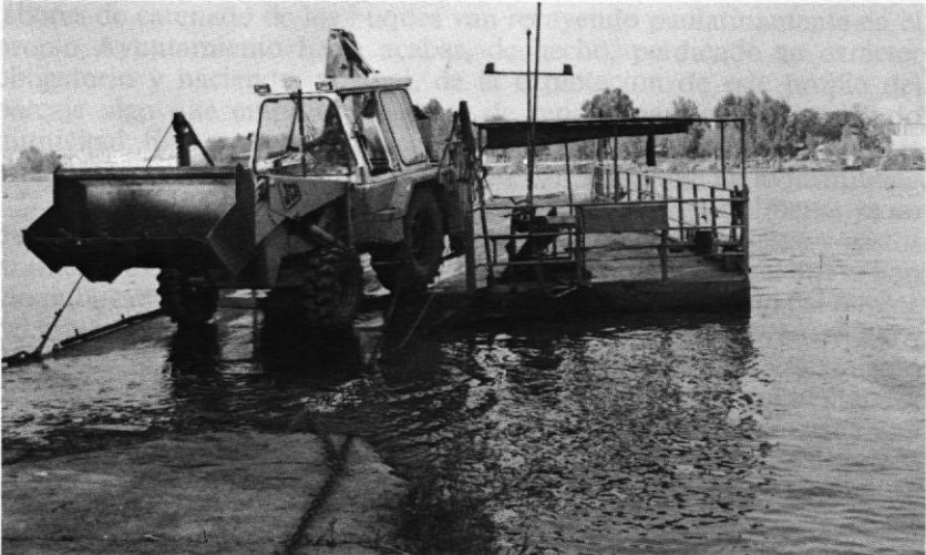
"Las pesadas máquinas suben o bajan por rampas construidas ex profeso". (Foto A. SOSA)
